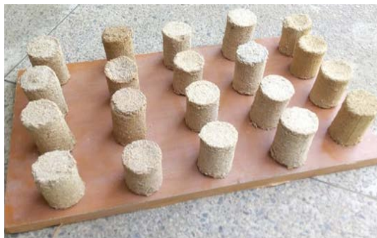
Sample B Orange peel: 80 % Corn cob: 20 %
