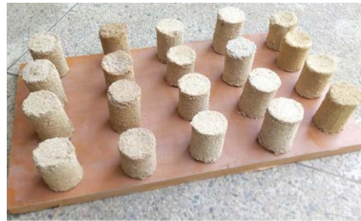
Sample C Orange peel: 50 % Corn cob: 50 %
