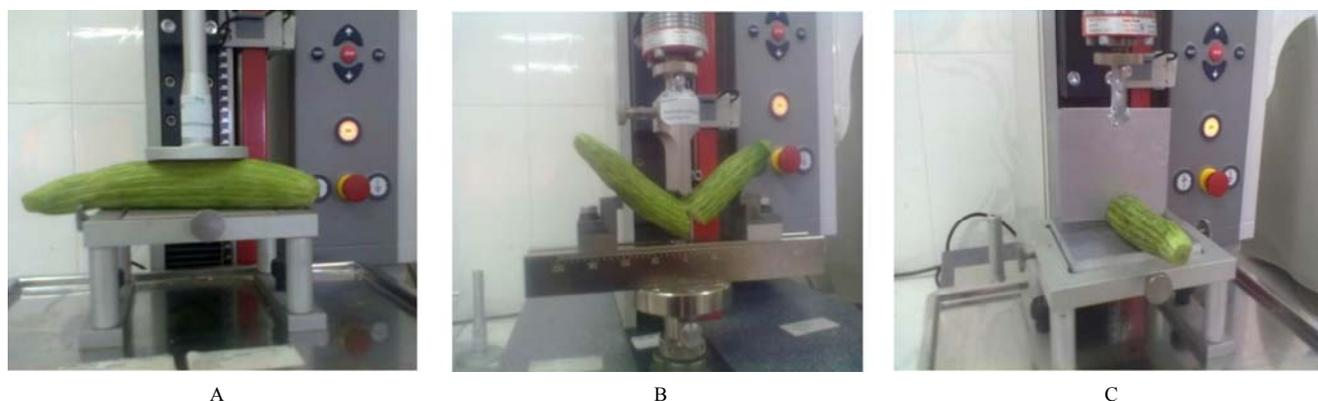
Figure 1 A) Bruise test, B) Break test and C) Shear test
