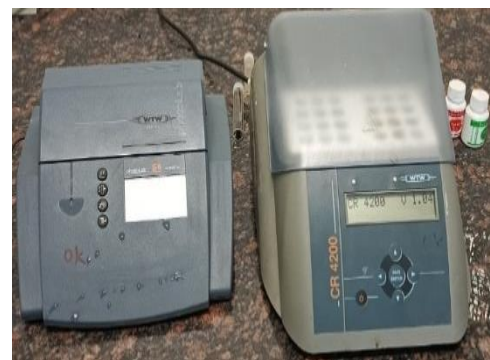
(c) Photo Meter (d) COD Digester
